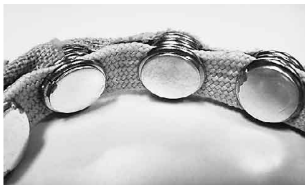
図2 純銀円盤電極による筋電ベルトの外観(上)と電極のアップ(下)
