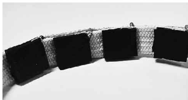
図3 導電ゴムシート電極による筋電ベルトの外観(上)と電極のアップ(下)
